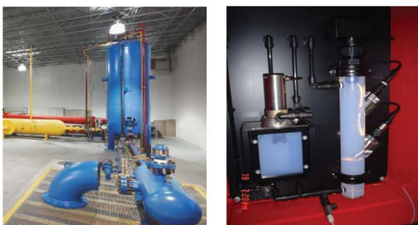
a. Hệ thống Flow Loop ở quy mô lớn.
